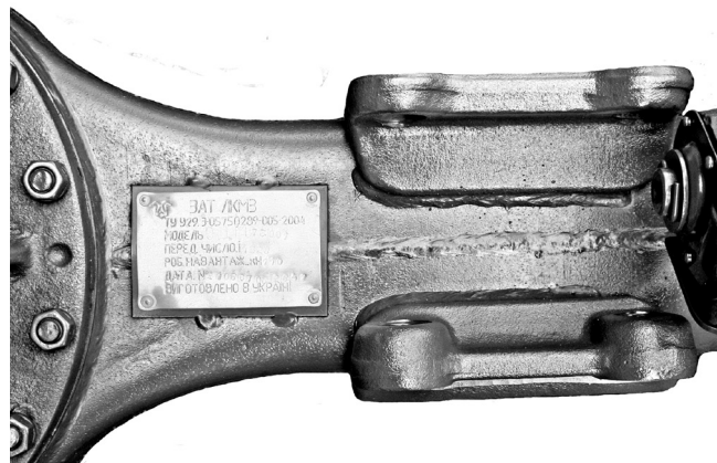
Рисунок 1.14 — Расположение маркировочной таблички ведущего моста
