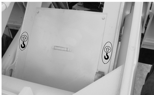
Рисунок 1.8 — Расположение знаков «Место строповки» на передней полураме
