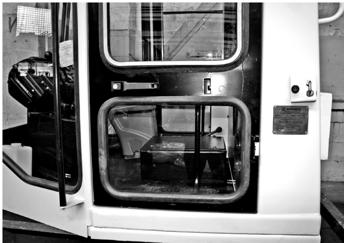
Рисунок 1.9 — Расположение маркировочной таблички кабины
