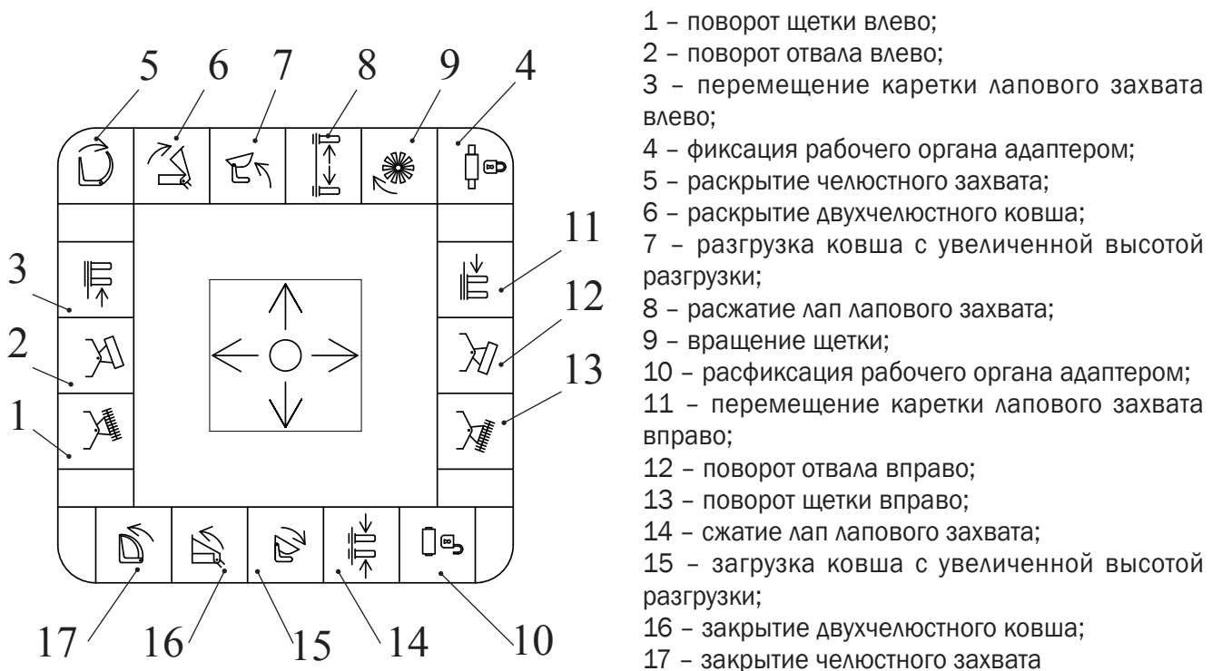
Рисунок 2.8 — Табличка управления рабочими органами погрузчика универсального АМКОДОР 332С4-01
