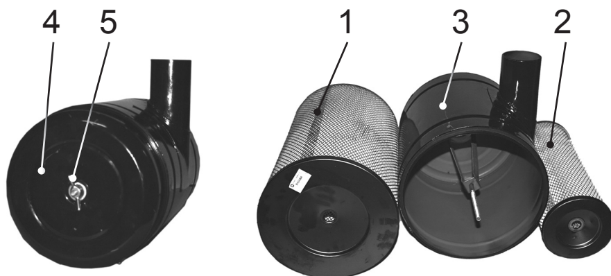
1 - элемент фильтрующий основной; 2 - элемент фильтрующий контрольный; 3 - корпус; 4 - поддон; 5 - гайка-барашек
