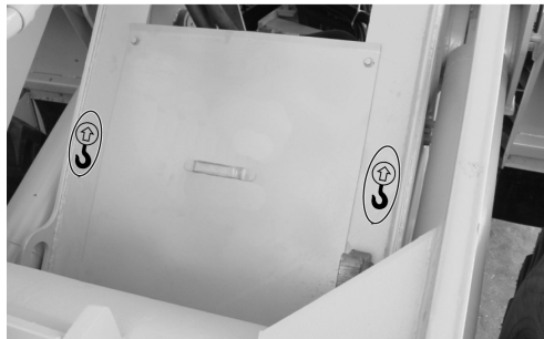
Рисунок 1.16 — Расположение знаков «Место строповки» на передней полураме
