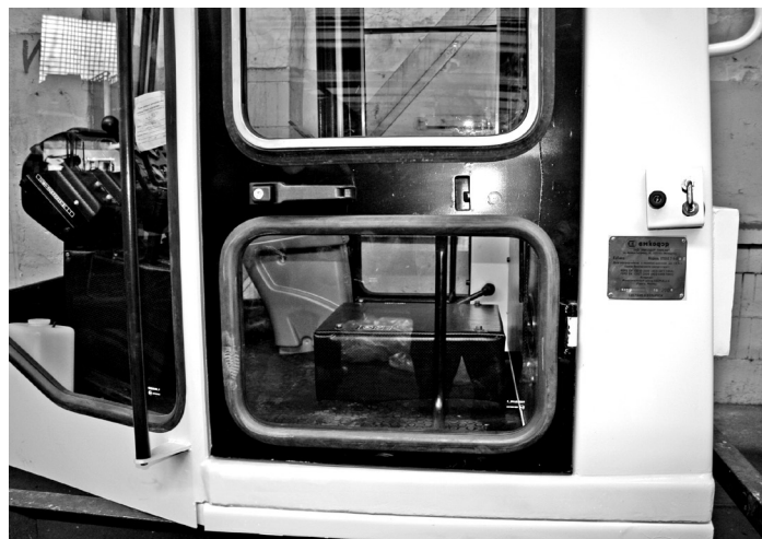
Рисунок 1.17 — Расположение маркировочной таблички кабины
